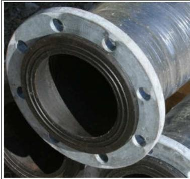
Die Bauart **FL** besitzt das geringste Gewicht unter den Flanschkonstruktionen der immuG. Optimale Dichtungseigenschaften erreicht eine FL-Flanschverbindung bei einer Kompression der Dichtfläche um etwa 20%. Als Montagehilfe bieten wir dafür optional Distanzhülsen an, siehe Blatt 10.
