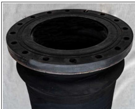
In Rohren mit Stutzenflanschen ist ein Stahlstutzen auf den Innengummi aufgesetzt. Die textilen Druckträger sind auf der Stutzen-Außenseite verankert. Diese Konstruktion eignet sich für extreme Anforderungen aus Längs-Zugkräften oder Seitenzug.
