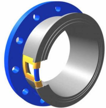
Die Bauart **FLR** ist eine Variante des FL mit einer zusätzlichen Metallplatte in der Dichtfläche, was die Druckbelastbarkeit erhöht. So werden Vorteile eines flexiblen Losflansch- und eines robusten Festflansch-Systems kombiniert. FLR-Flansche eignen sich insbesondere für die Verbindung von Gummirohren mit Rohren aus Stahl oder Kunststoff.
